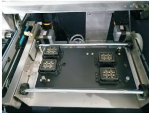
EL MÓDULO DE LIMPIEZA HIDRATANTE AUTOMÁTICO GARANTIZA LA LIMPIEZA Y LA ESTABILIDAD DE TRABAJO.
