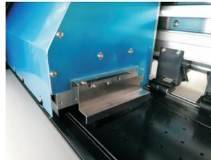
EL SISTEMA DE PREVENCIÓN DE COLISIONES DE LOS CABEZALES DE IMPRESIÓN PUEDE EVITAR EFICAZMENTE QUE EL CABEZAL SE BLOQUEE DURANTE LA IMPRESIÓN
